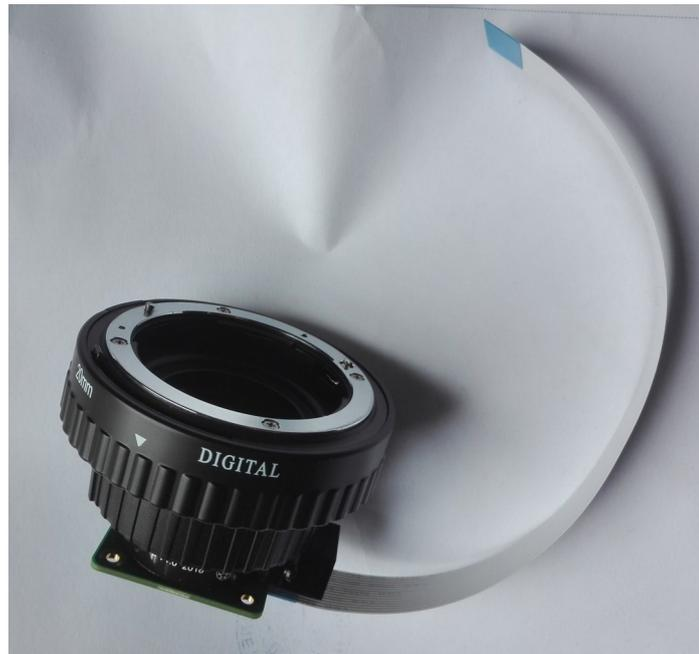
Exemple de fixation de la caméra sur un objectif de 85 mm de focale ouvert à 3.5.
