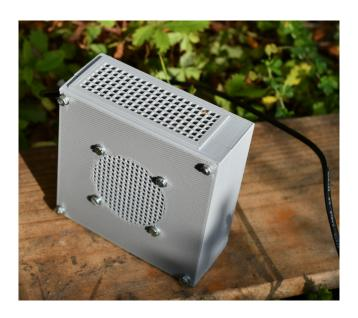
L'ouverture ronde cache le ventilateur qui aspire l'air extérieur. Celui-ci circule dans la « boîte » et ressort par l'ouverture rectangulaire. Les besoins en électricité (5 volts) pour la carte Pi, la caméra et le ventilateur sont fournis via un cable USB.
