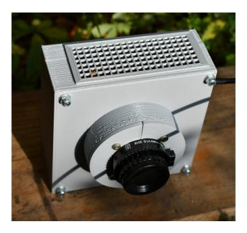
La caméra est fixée en avant de la carte Pi, par l'intermédiaire d'une platine. Elle dépasse assez pour permettre d'utiliser différents types de raccords.
