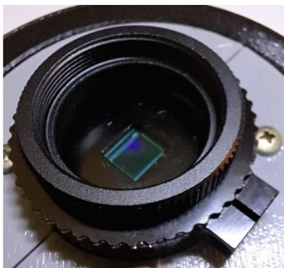
III. Caméra Pi HQ, avec raccord à la norme C. La diagonale est de 7,9 mm et la dimension de chaque photo-site carré, de 1,55 micromètre.
