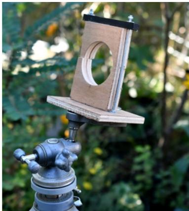
Support très simple utilisant une chute de contreplaqué de 10 mm et deux morceaux de tige filetée. L'ensemble est fixé sur le pied photo via un boulon et un écrou papillon.
