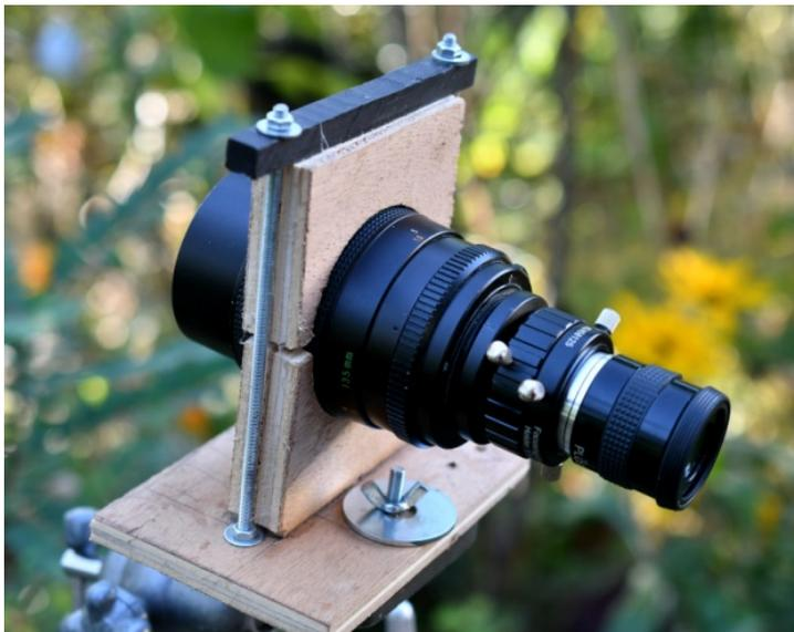
La lunette courte est serrée entre les deux demi-pièces de contreplaqué. L'oculaire de 20 mm est en place. Les deux pièces qui serrent la lunette font obstacle à la visée à vue.
