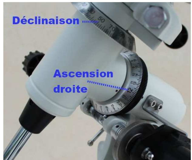
Couronnes graduées permettant de pointer aux coordonnées
