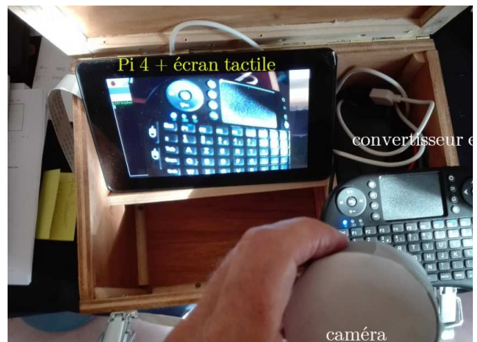
La main tient la caméra équipée d'un petit objectif. L'image capturée s'affiche sur l'écran tactile. Le mini clavier est posé sur un angle de la boîte.
